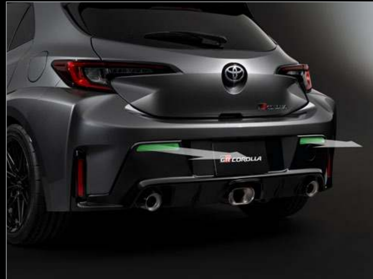
リヤ ■ リヤバンパー形状（操安性向上） ■ リヤバンパーダクト（ドラッグ低減、操安性向上）
