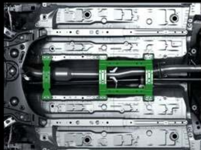
床下トンネルブレース
