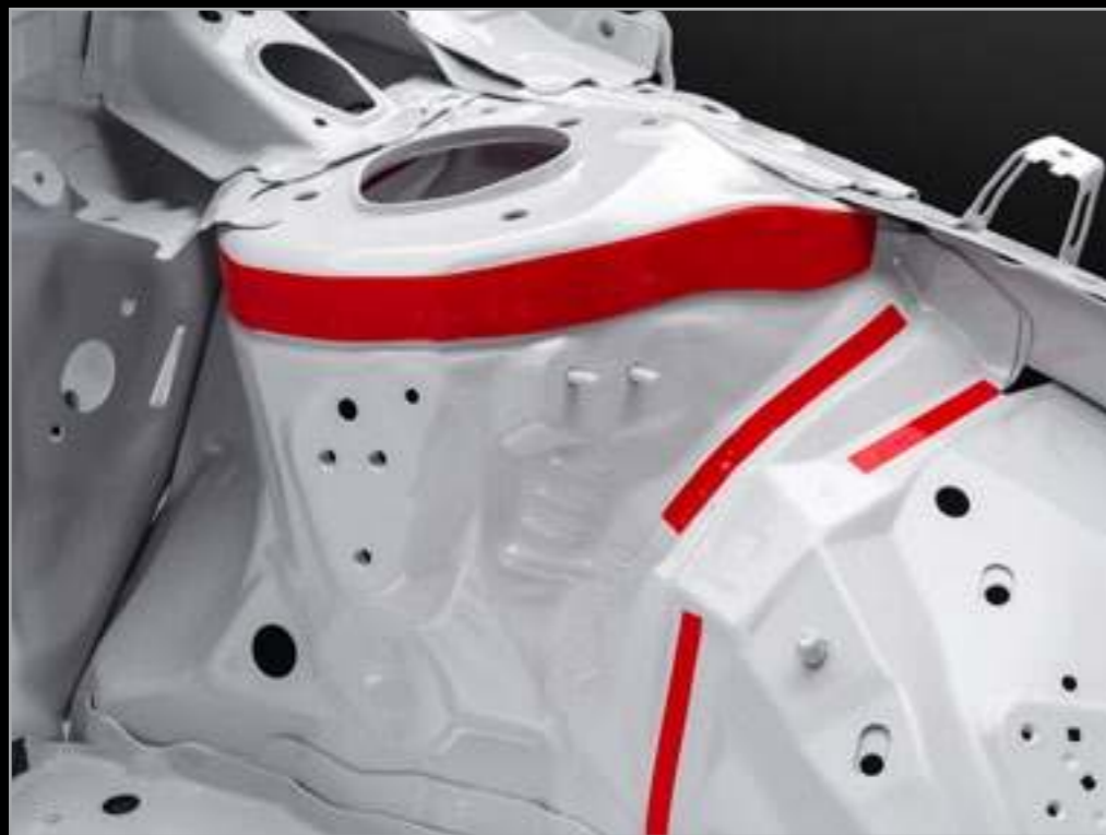
フロントサスタワースポット溶接
