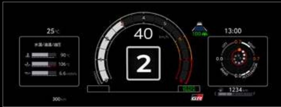
1眼タコリング表示 初期設定① 中央：ギヤ段 左：油水温 右：Gモニター
