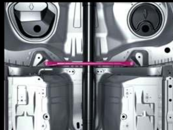
タンク前床下ブレース
